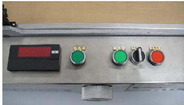
图 2 角度操作显示面板
