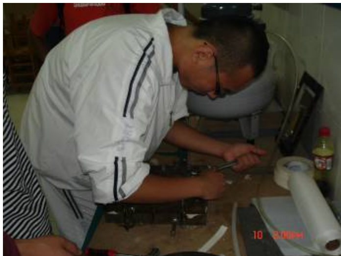
步骤三：上紧模具（RTM成型）
