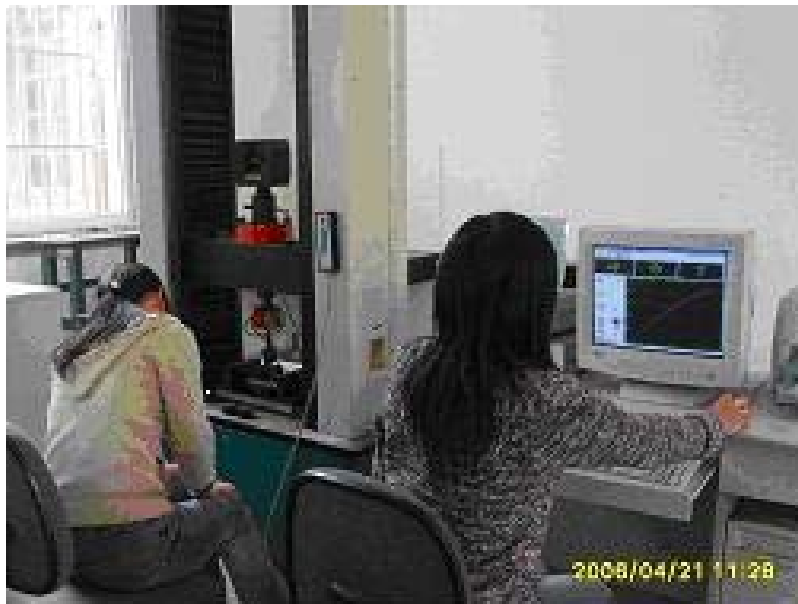
材料万能试验机
