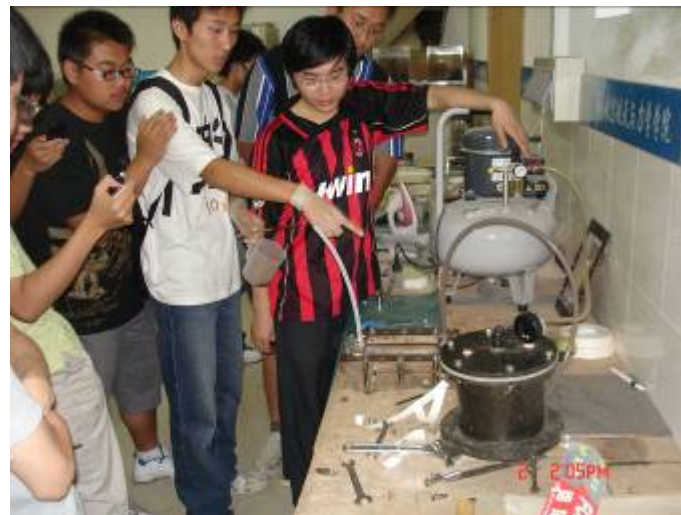
步骤四：树脂注塑（RTM成型）
