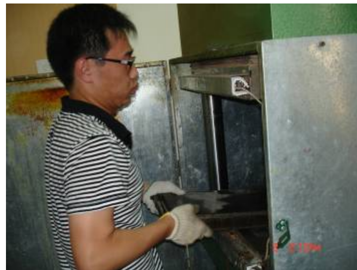
步骤四：压制复合材料层合板 (热压成型)
