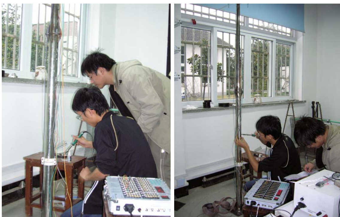
开放实验-学生正在粘贴应变片
