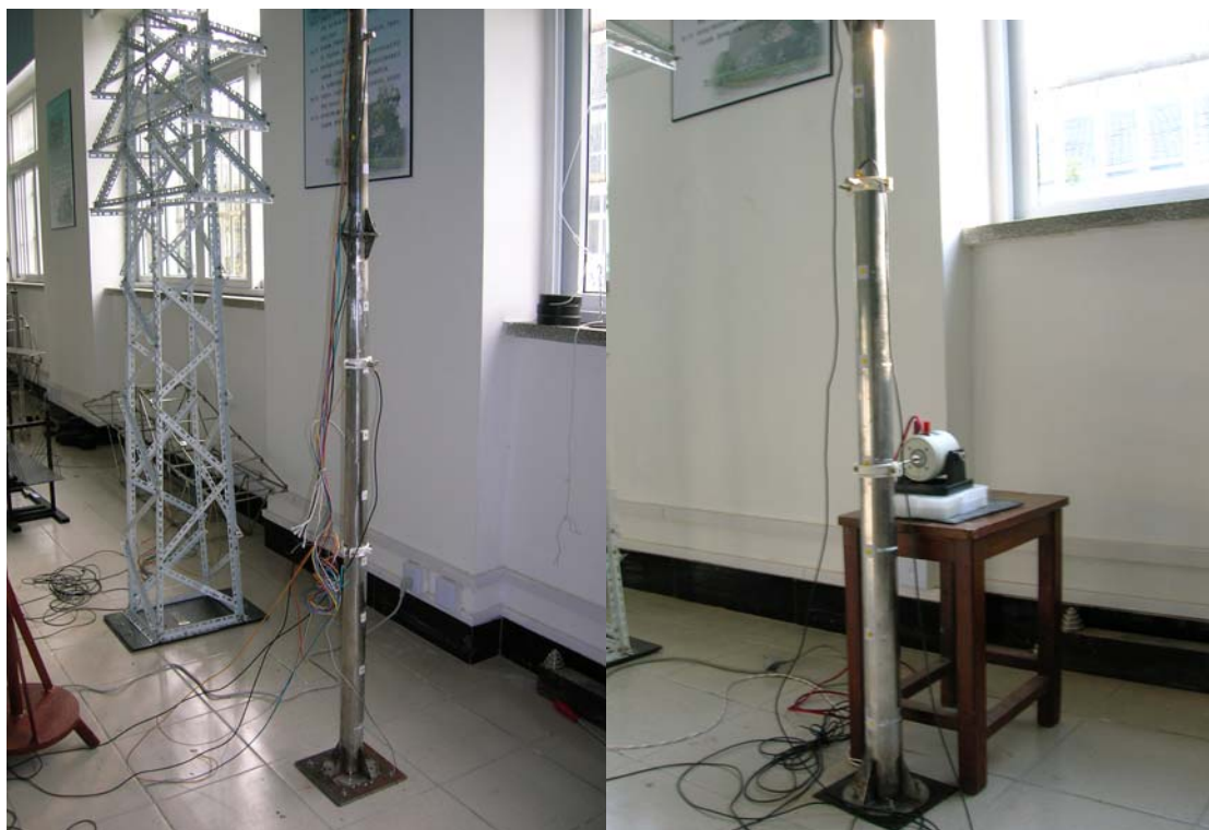
粘贴应变片的塔桅结构模型
